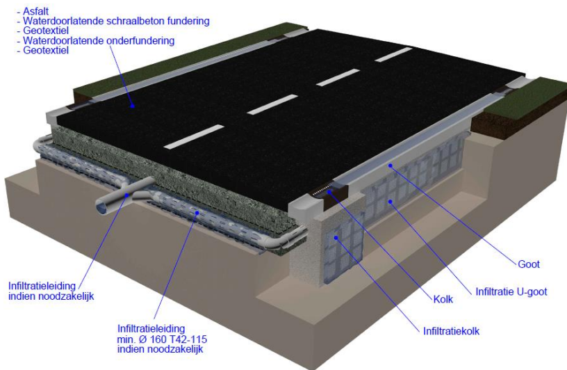
Figuur 25: Schematische voorstelling van klimaatrobuuste wegopbouw met buffering en infiltratie in de onderfundering (© Blauwgroen Vlaanderen).
