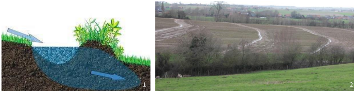
Figuur 36: (1) Schematische voorstelling van een swale in landbouwgebied (© VLM); (2) Aangelegde bioswales op een pilootproject (© VLM)
