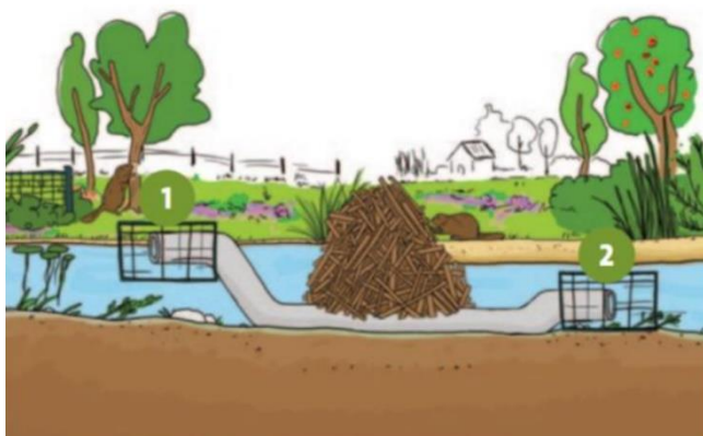
Figuur 43: Schematische voorstelling van een omleggingsbuis in een beverdam. Met (1) de instroom op 80 cm waterhoogte en (2) de uitstroom (© Aquafin)
